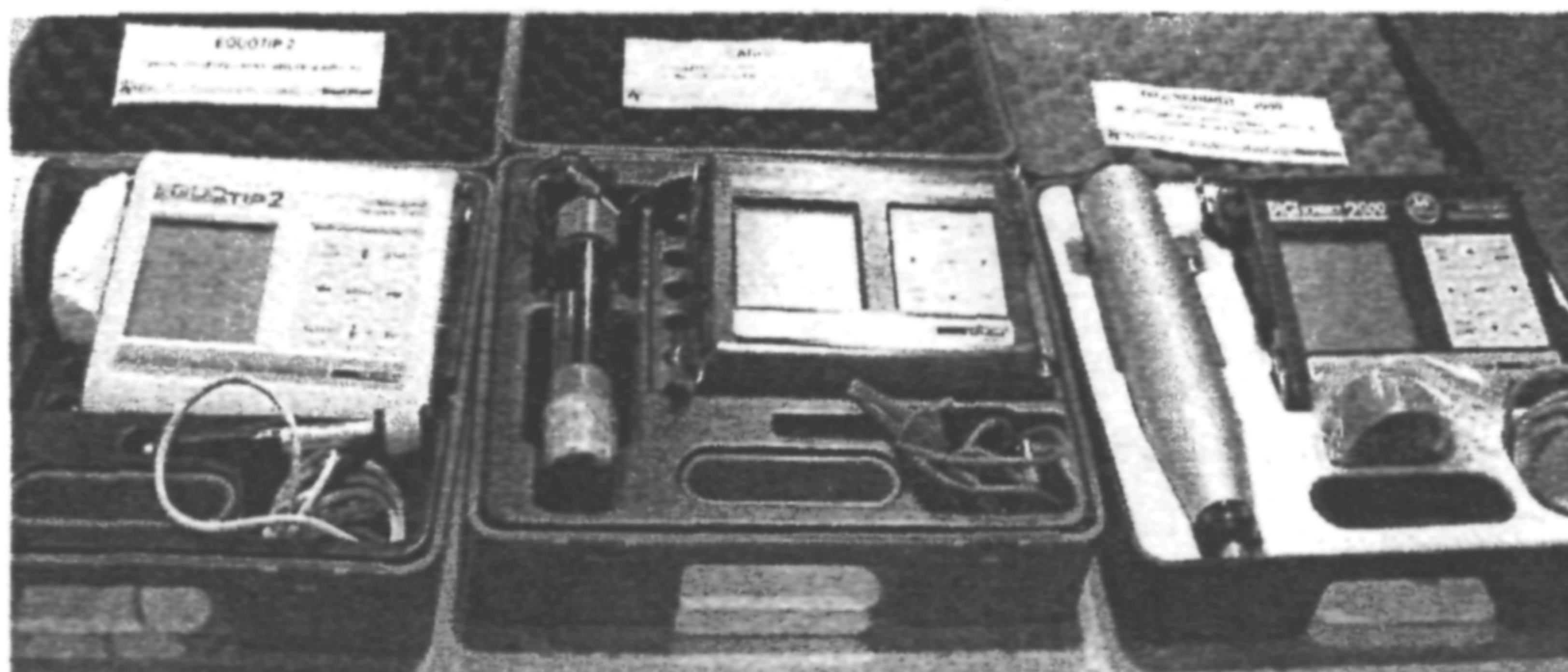
Рисунок А.6. Приборы неразрушающего контроля железобетонных конструкций:
